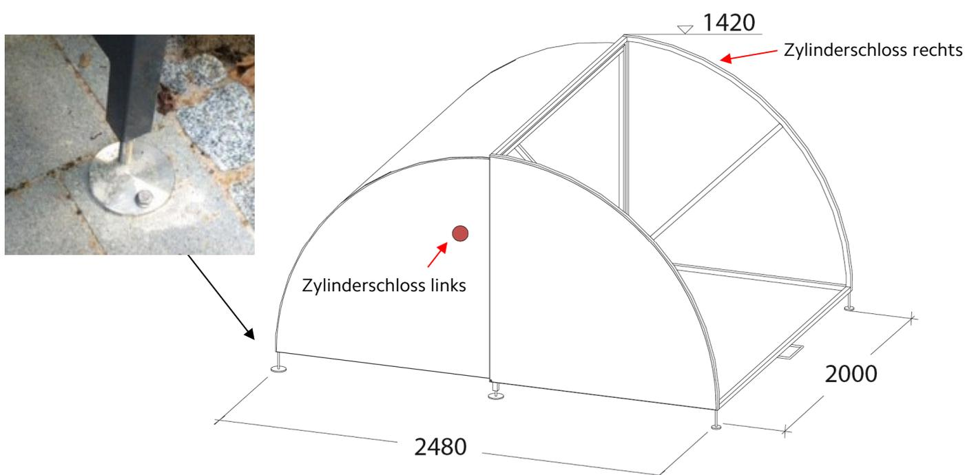
Der Unterstand Pandora wird an 4 Punkten (hinten und mittig) am Boden fixiert
