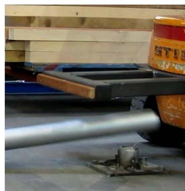
Le test pratique a confirmé l'efficacité du point de rupture et du câble de sécurité. En cas de sinistre, un câble de sécurité retient le potelet et empêche que les personnes qui se trouvent à proximité de l'incident ne soient blessées.
