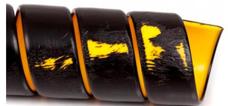
Velo-Protect avec témoin d'usure utilisé après une longue durée de service
