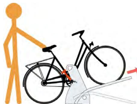
3. Schieben Sie das Velo weiter. Die Pedalachse bewegt sich selbsttätig in den Halteschlitz.
