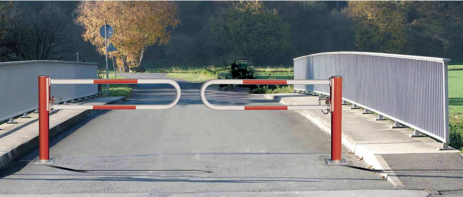
Leicht zu bedienende Schranke von solider Konstruktion. Der Schrankenausleger rastet automatisch alle 90° ein. Drehpfosten aus Stahl, verzinkt und zusätzlich rot pulverbeschichtet. Schranken-Ausleger aus Aluminium-Rundrohr, weiss beschichtet mit roten Reflexstreifen für eine gute Sichtbarkeit.
