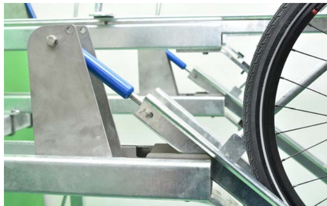
Le système de suspension hydro-pneumatique de Velopa permet un mouvement uniforme et en douceur.
