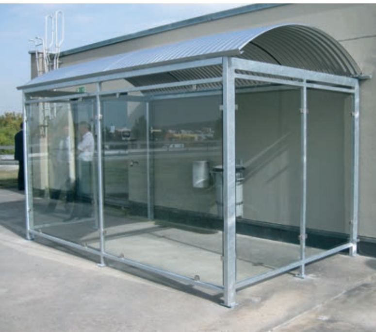
Die Dachwölbung des Smoke lässt den Rauch ideal entweichen
