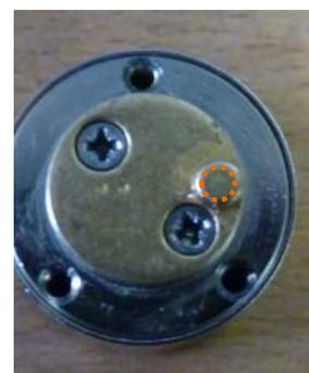
Monter l'entraîneur à l'aide de 2 vis à tête fraisées sur le cylindre.
