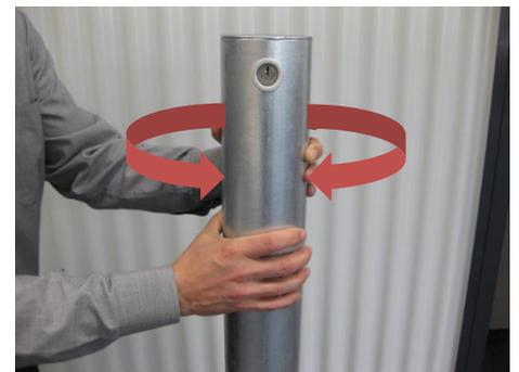
Tournez la bitte d'amarrage jusqu'à ce que les orifices de la fermeture à baïonnette se superposent et se verrouillent à l'intérieur. Lorsqu'on fait pivoter légèrement la bitte d'amarrage, la barre de fermeture se verrouille automatiquement dans la douille de sol.
