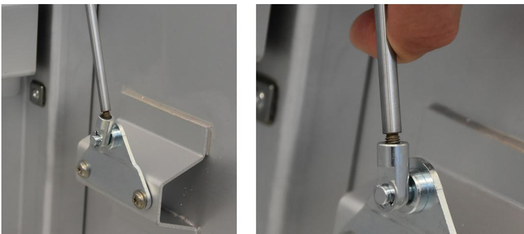
Les amortisseurs à gaz montés sur le couvercle du coffre sont maintenant introduits dans les logements montés sur les panneaux latéraux et fixés.
