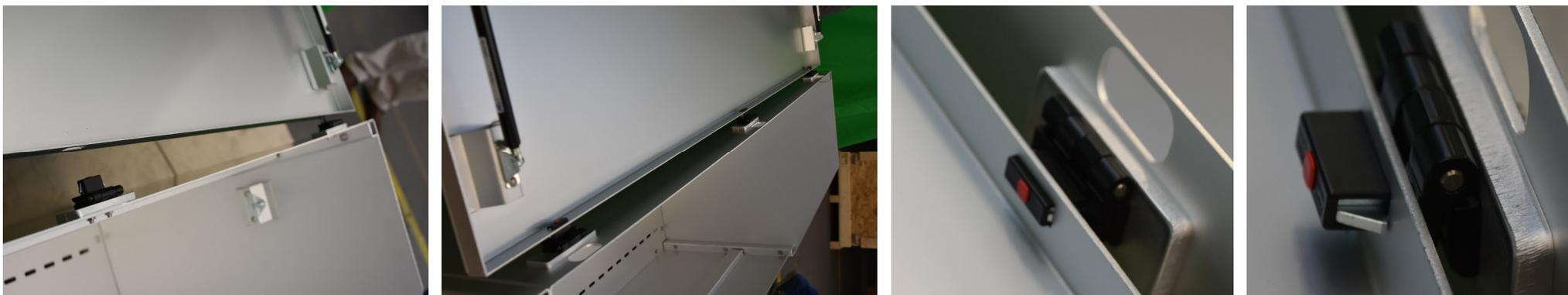
Redressez la boîte pour le montage du couvercle. Les charnières fixées sur le coffre sont introduites dans les perforations du couvercle et verrouillées en position finale par une légère pression.
