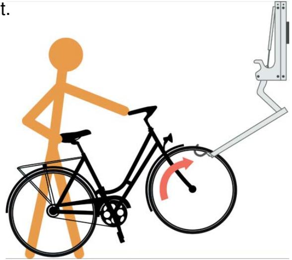
2. Tirer le vélo en arrière avec peu d'élan ...et le bras élévateur remonte automatiquement.
