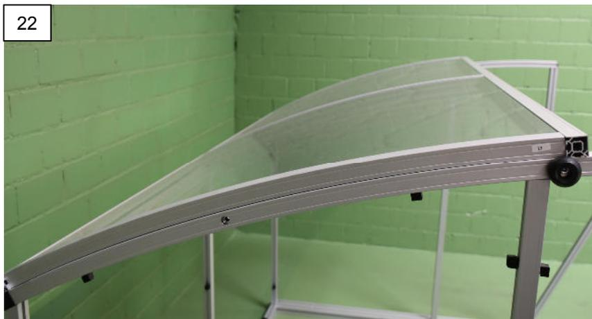
Legen Sie das nun zusammen gebaute «bewegliche Dachelement» auf das Dach des LightRoof. Die Inbusschraube (siehe Bild 21a) wird zur Rückseite des LightRoof gerichtet.
