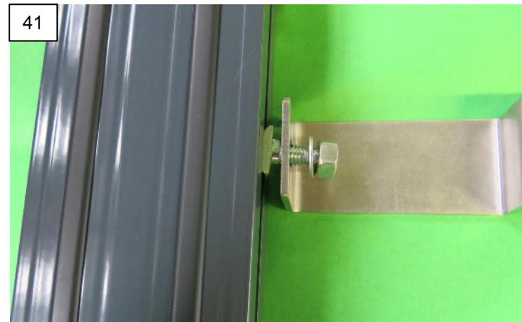
Führen Sie die an den Verbindungsbügeln angebrachten T-Schrauben in die Schiene des Bodenprofils ein.
