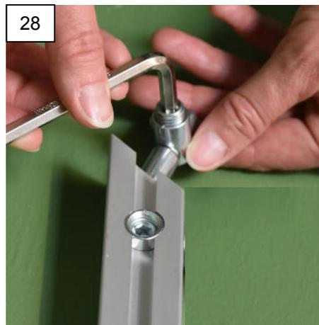
Lösen Sie an den **Jochverbindern Nr. 19 und 22** beidseits die Schrauben der Gewindehülsen. Entfernen Sie die Gewindehülsen und setzen Sie diese in die Aussparungen der Jochprofile Nr. 17, 18, 20 und 21 so ein, dass das Loch Richtung Profilende zeigt.
