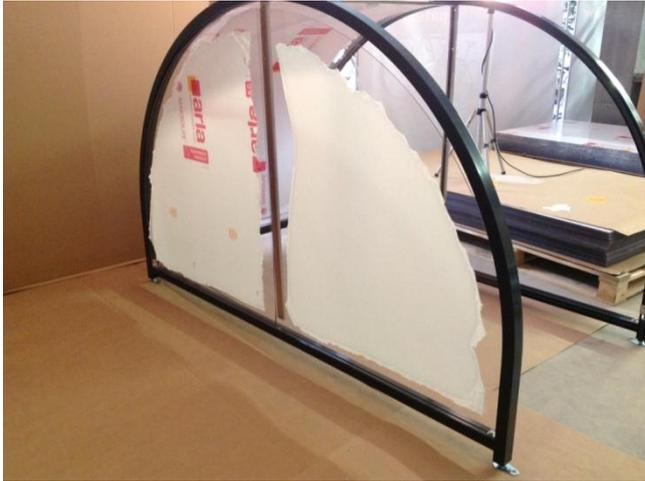
**21) Längsverbinder anlösen und durch zwei Personen links und rechts mit den Seitenscheiben hochschieben. Anschliessend wieder festziehen.**
