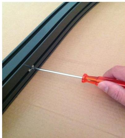
Nutenstein mit Schraubenzieher in Position schieben
