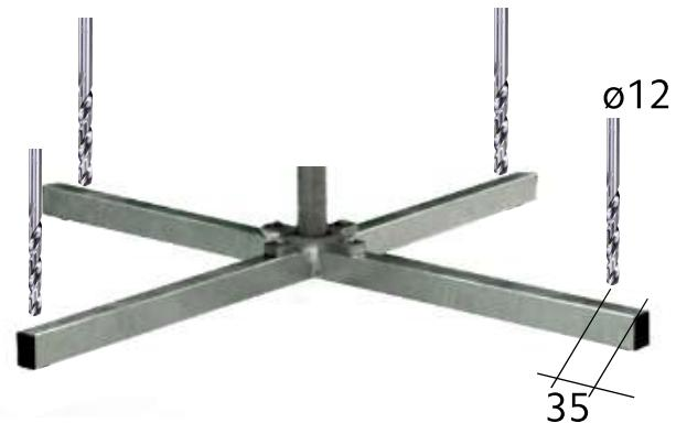
Bohren Sie im Standfuss oberhalb der abgeschraubten Nivellierfüsse 4 Löcher ø12 mm
