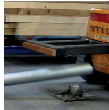
Le test pratique a confirmé l'efficacité du point de rupture et du câble de sécurité. En cas de sinistre, un câble de sécurité retient le potelet et empêche que les personnes qui se trouvent à proximité de l'incident ne soient blessées.
